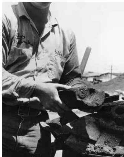
Figura 3. Piezas grandes de pedacería de hierro retiradas automáticamente de la línea de proceso
