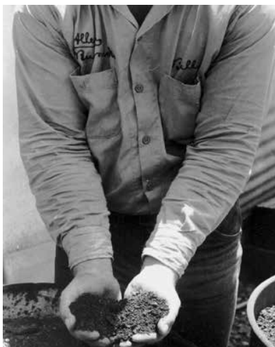
Figura 2. Contaminantes finos de hierro retirados de una profundidad de carga de tres pulgadas
